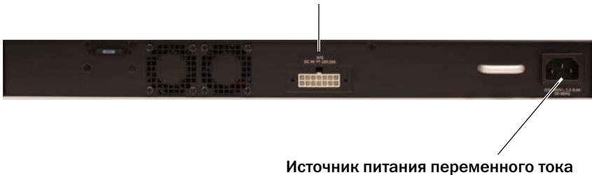
Рисунок 1-10. Подключение коммутатора N1548 к сети переменного и постоянного тока Источник питания постоянного тока (дополнительно)
